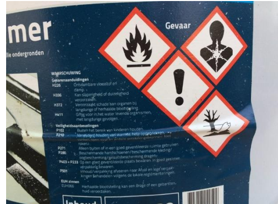
Afbeelding 1.1 - Etiket op dakbedekking primer. Rechtsboven pictogram GHS08 voor Gezondheidsschade op lange termijn.
