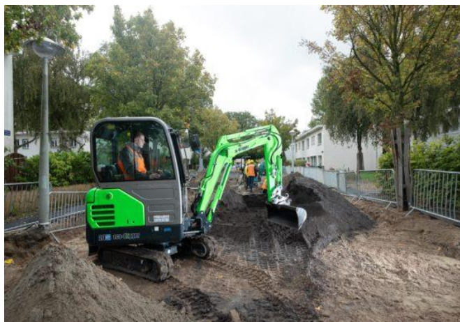
Afbeelding 9.5 - Een elektrische minigraver aan het werk. Foto afkomstig uit het artikel in noot 155.
