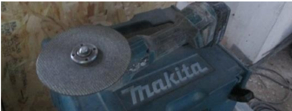
Afbeelding 2.5 - Haakse slijper zonder schermkap, handvat en afzuiging – een gevaar voor zowel veiligheid als gezondheid.
