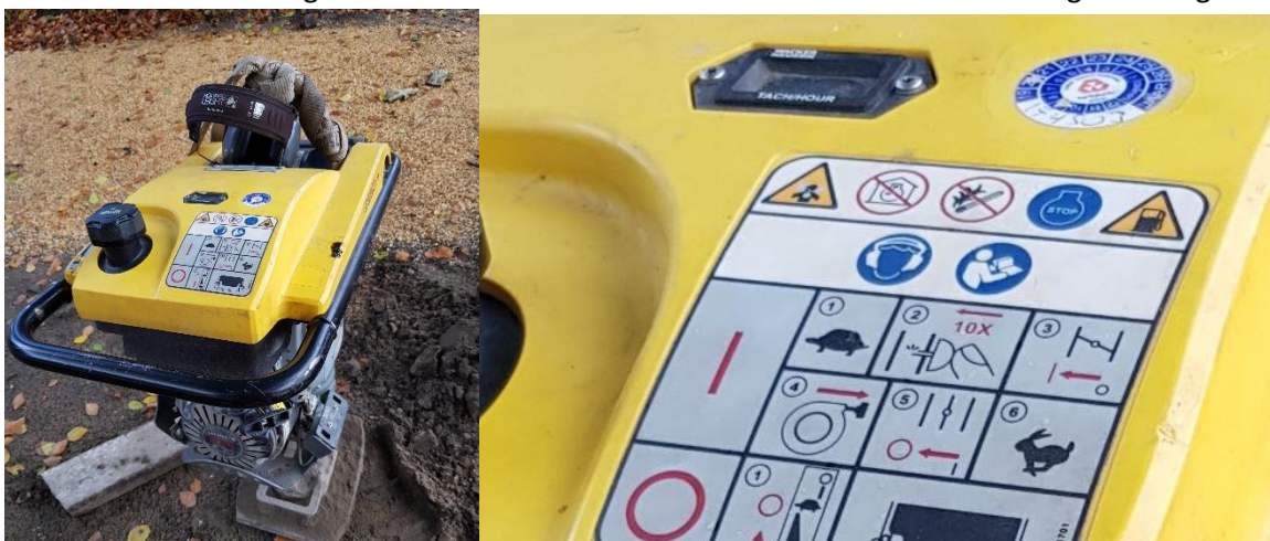
Afbeelding 9.1 - Trilstamper met linksboven op het bedieningspaneel een waarschuwingssymbool i.v.m. het vrijkomen van verstikkende CO-damp.
